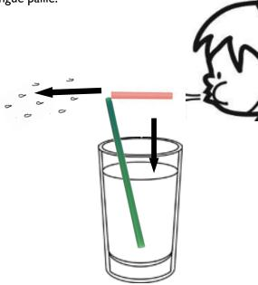
En soufflant **très fort** dans la courte paille, l'air au-dessus de la longue paille est poussé et la pression de l'air au-dessus de celle-ci diminue. Attendu que l'air n'exerce plus autant de pression sur l'eau présente dans la paille, l'eau sort. La pression atmosphérique au-dessus de l'eau dans le verre pousse sur l'eau et la fait remonter par la paille.
